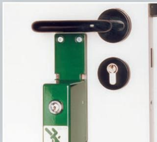
Eine alarmfreie Umstellung auf eine Dauerfreigabe der Tür ist mit Hilfe des Geräteschlüssels möglich. Dazu lässt man den Türwächter um 180° ausschwenken und einrasten.
