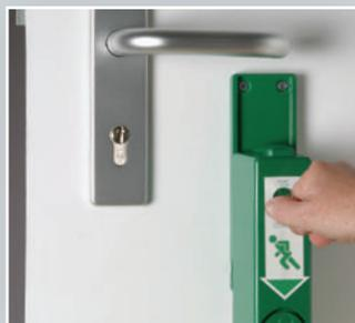
Soll die Tür normal begehbar sein, kann mit dem Geräteschlüssel der Türwächter durch Verschieben nach unten alarmfrei in eine Dauerfreigabeposition gebracht werden.
