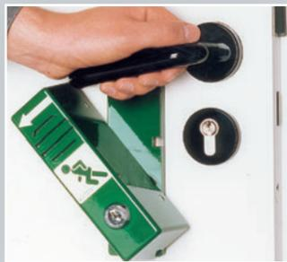
Zum Öffnen der Tür muss der Türwächter zur Seite gedreht werden. Der Türwächter rastet in seiner Schrägstellung ein und gibt die Klinke zur Betätigung frei. Dies löst einen akustischen Alarm aus (ca. 95 dB/1 m), der auf Gefahr oder Missbrauch aufmerksam macht. Aufheben des Alarms nur mit Schlüssel möglich!
