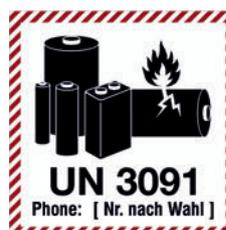
Verpackungsetiketten UN 3091 für Lithium-Metall-Batterien mit oder in Ausrüstungen verpackt - mit Text nach Wahl
