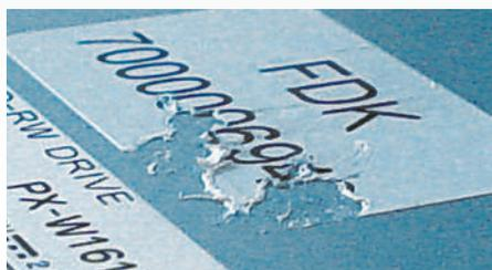
Dokumentenfolie – selbstzerstörend bei Ablöseversuch
